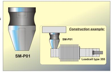
De montagehulpstukken maken het projecteren en monteren van krachtopnemers eenvoudig en veilig. Om horizontale krachten, ontstaan door temperatuureffecten, te elimineren is een speciaal samengestelde NBR (Perbunan Acrylnitril Butadieen) rubber compound toegepast. Hierdoor blijft de nauwkeurigheid behouden. Metalen delen RVS 304. Alle horizontale vlakken zijn gefreesd.
