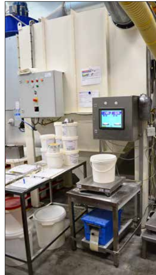
De receptenautomaat met software van Penko Engineering is voorzien van een plateau voor het wegen in kilo's en een plateau voor het wegen in grammen grondstoffen; de gebruiksvriendelijkheid is maximaal
