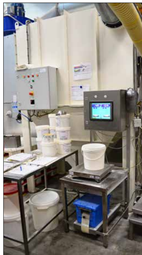
De receptenautomaat met software van Penko Engineering is voorzien van een plateau voor het wegen in kilo's en een plateau voor het wegen in grammen grondstoffen; de gebruiksvriendelijkheid is maximaal
