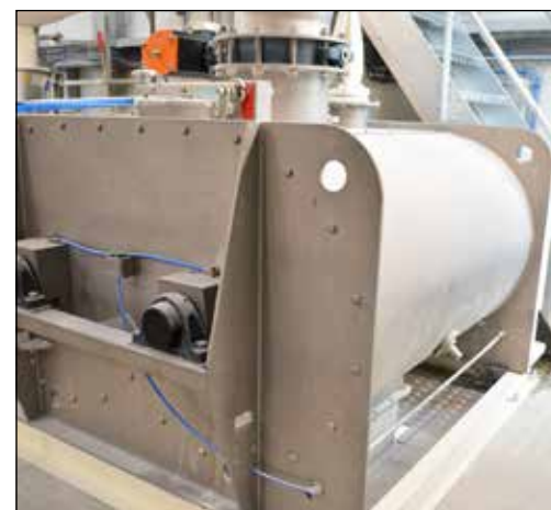
Deze snelle machine mengt een batch allergenvrij mixrecept in poedervorm binnen twee minuten
